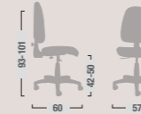
LM 14 Sedia dattilo ergonomica alta senza braccioli mov. 10L. High ergonomic typing chair without armrests mov. 10L.
